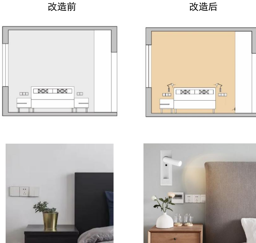
图 31 床头照明安装做法及效果示意
