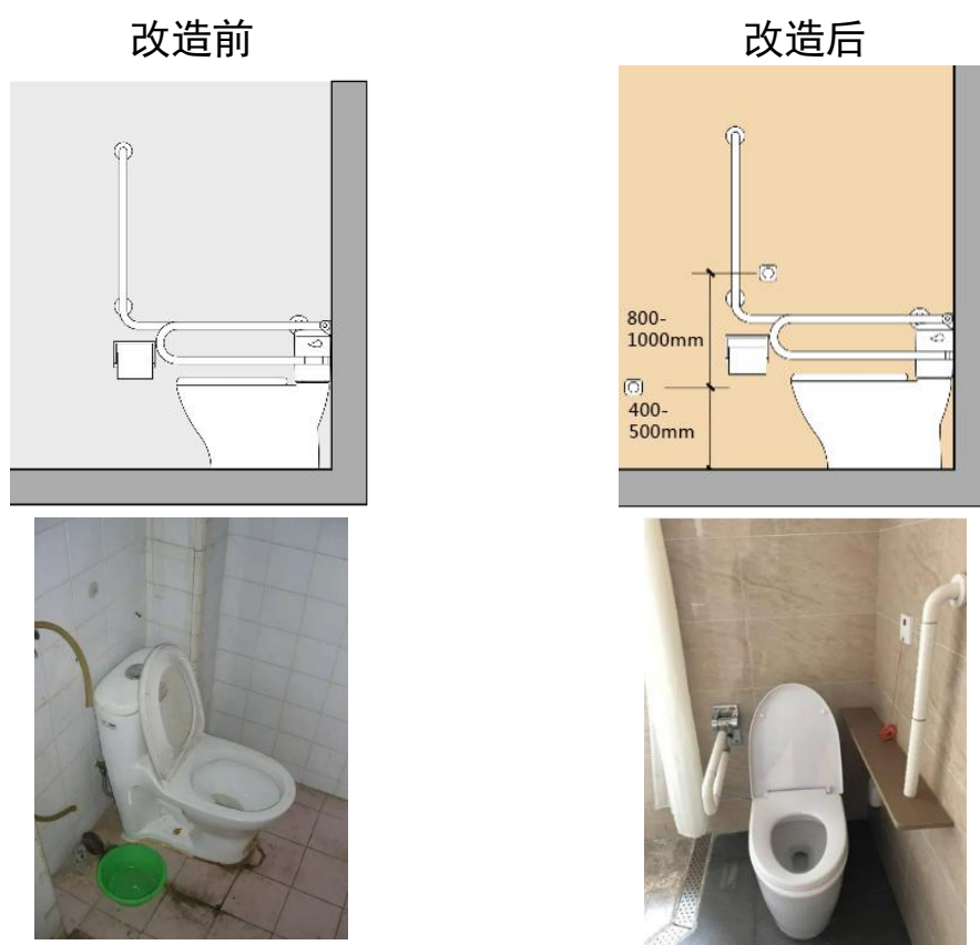
图 42 紧急呼救装置安装做法及效果示意
