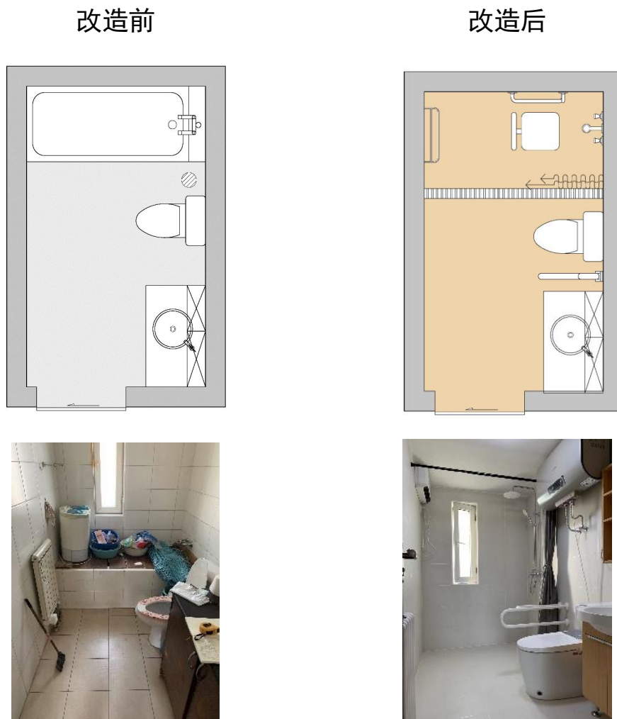
图 44 浴缸/淋浴间改造方法及效果示意
