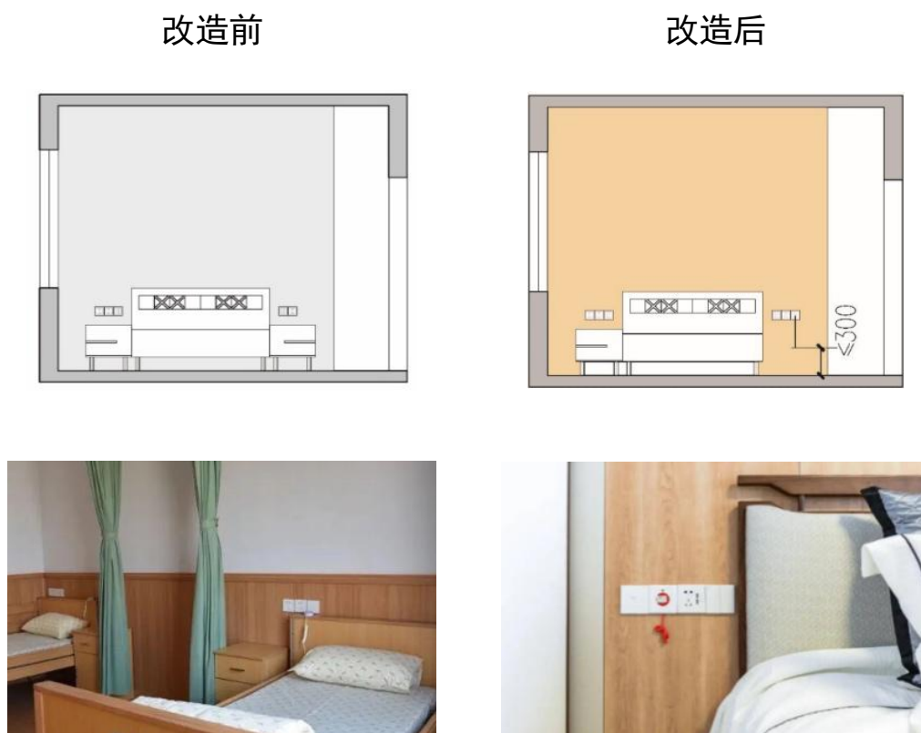
图 30 紧急呼叫装置安装做法及效果示意
